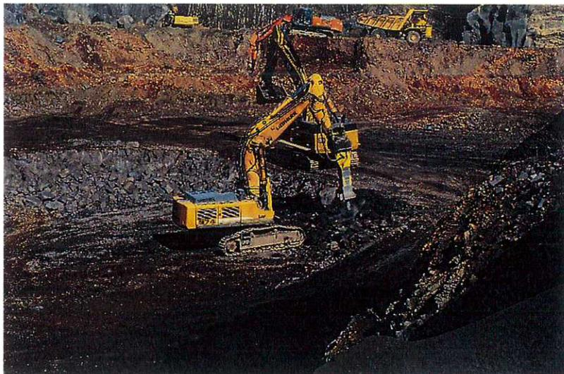
Aus den nicht werksteintauglichen Basaltlavaresten wird mittels Hydraulikknäpper, welcher an einem Hitachi ZX350 angebracht ist, ein Aufgabegut 0-700 mm hergestellt.
