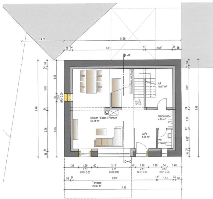
**GRUNDRISS ERDGESCHOSS** [M 1:100]
